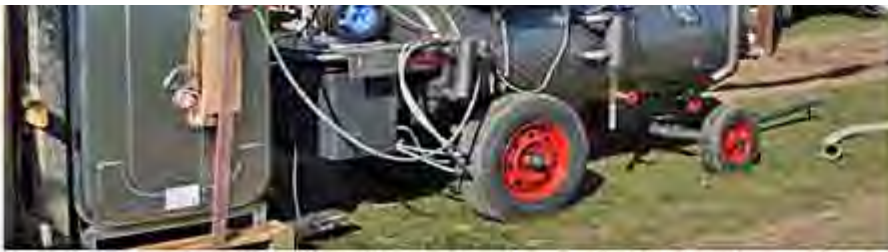
Dämpfautomat der Firma Möschle zur Dämpfung mit der Dämpfegge oder Foliendämpfung
